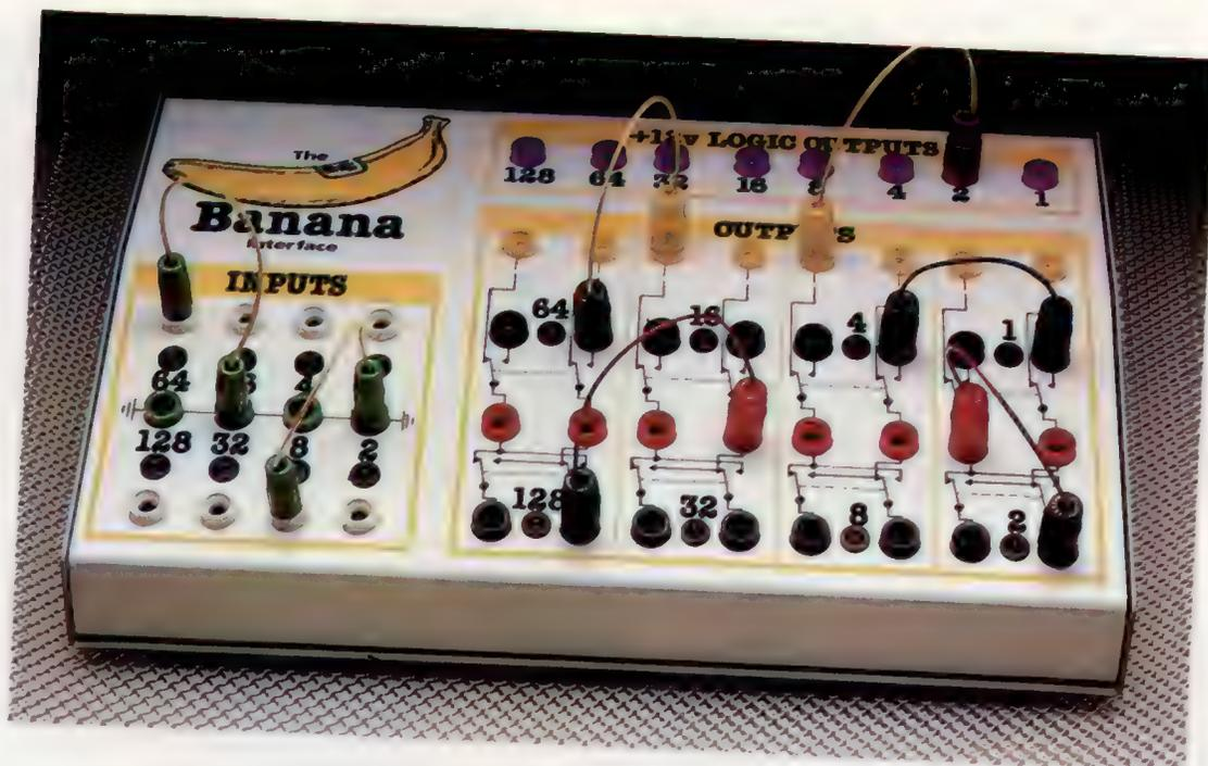
Nous avons déjà vu plusieurs de ces périphériques qui permettent aux ordinateurs de contrôler des mécanismes externes. Parmi les derniers modèles du marché, l'interface Banana est principalement destinée au milieu scolaire. Elle permet le contrôle de divers projets par le Commodore 64, en particulier.
